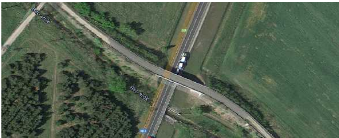
Fig.4.53 – Autostrada M15 half-profile (Budapesta – Hegyeshalom – Bratislava) – cu spațiu liber dedicate dezvoltării ulterioare
